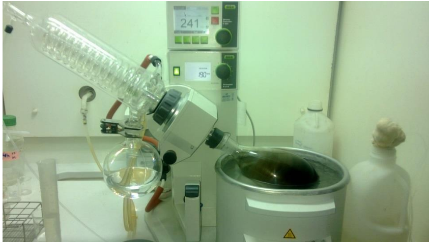
Εικόνα 13. Εξατμιστήρας με αντλία κενού (BUCHI, Vacuum controller V-850, Vacuum pump V-700, Rotavapor R-215, Heating bath B-491, HELLAMCO)
