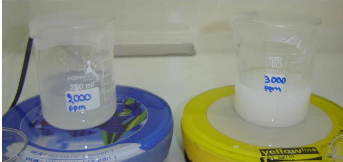
Εικόνα 24: Μακροσκοπική παρατήρηση διαλυμάτων αναφοράς διαφορετικής αρχικής συγκέντρωσης σε \text{Ca}^{2+} , 30 min μετά την Εικόνα 23.
