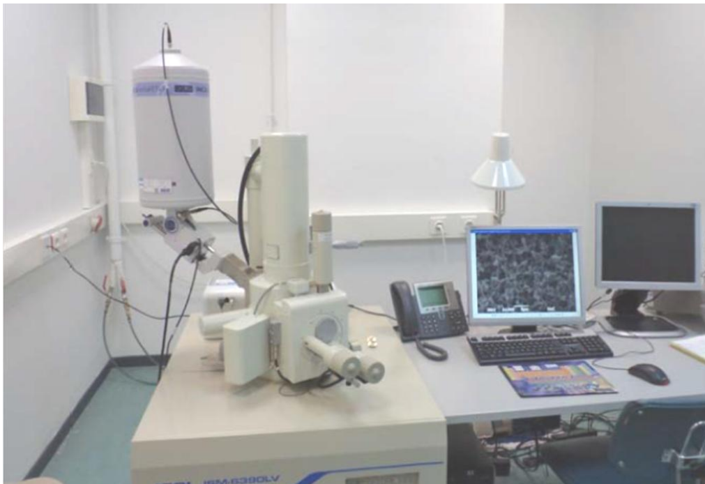
Εικόνα 18: Ηλεκτρονικό Μικροσκόπιο Σάρωσης (SEM), μοντέλο JSM6390LV της εταιρίας JEOL. Ελήφθη από την παραπομπή [44].
