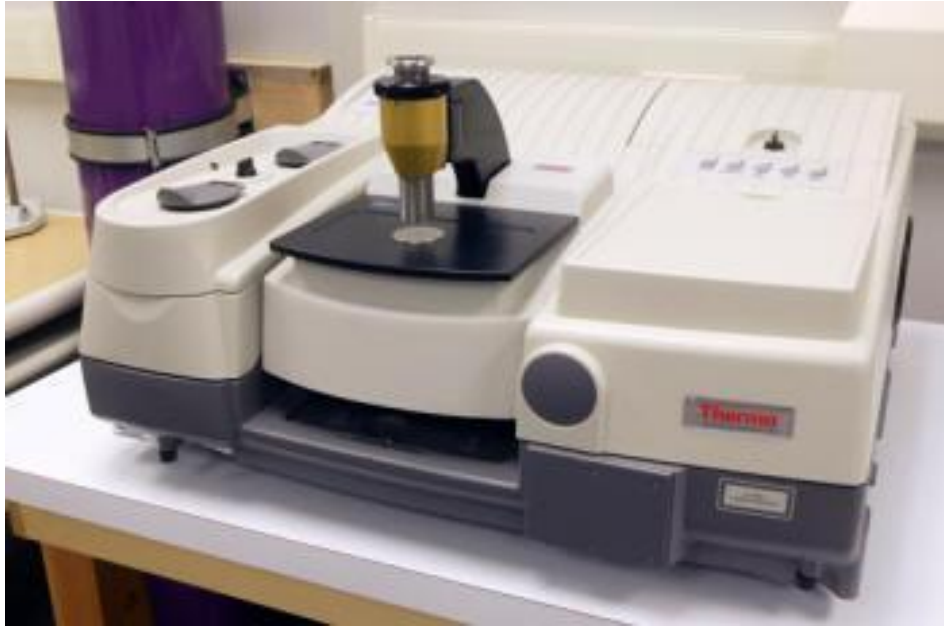
Εικόνα 19: Φασματοφωτόμετρο (ATR-FTIR), μοντέλο Nicolet 6700, της εταιρίας Thermo Electron Corporation. Ελήφθη από την παραπομπή [45]
