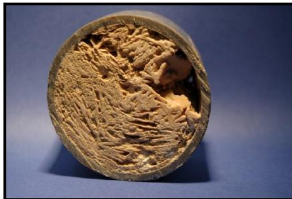
Εικόνα 15: Φωτογραφία σωλήνα που χρησιμοποιείται στις θερμές πηγές στη Νιγρίτα. Ελήφθη από την παραπομπή [6]
