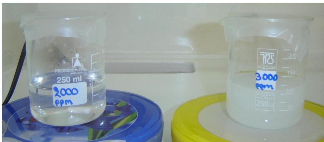
Εικόνα 23: Μακροσκοπική παρατήρηση διαλυμάτων αναφοράς διαφορετικής αρχικής συγκέντρωσης σε \text{Ca}^{2+} .
