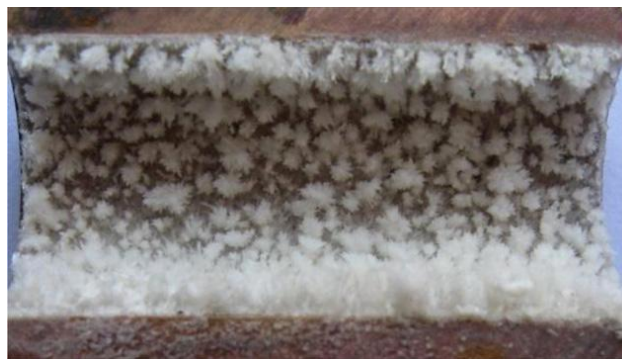
Εικόνα 1: Εγκάρσια κομμένος δακτύλιος πλάκας δοκιμής από εργαστηριακή διάταξη για τη μελέτη σχηματισμού εναποθέσεων αλάτων. Ελήφθη από την παραπομπή [2].
