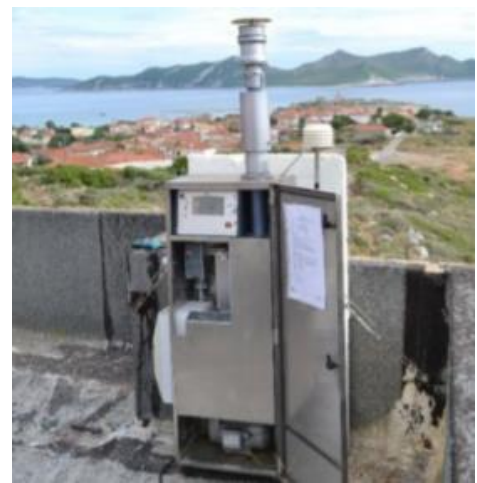
Εικόνα 10 : Δειγματολήπτης χαμηλού όγκου στη Μεθώνη.
