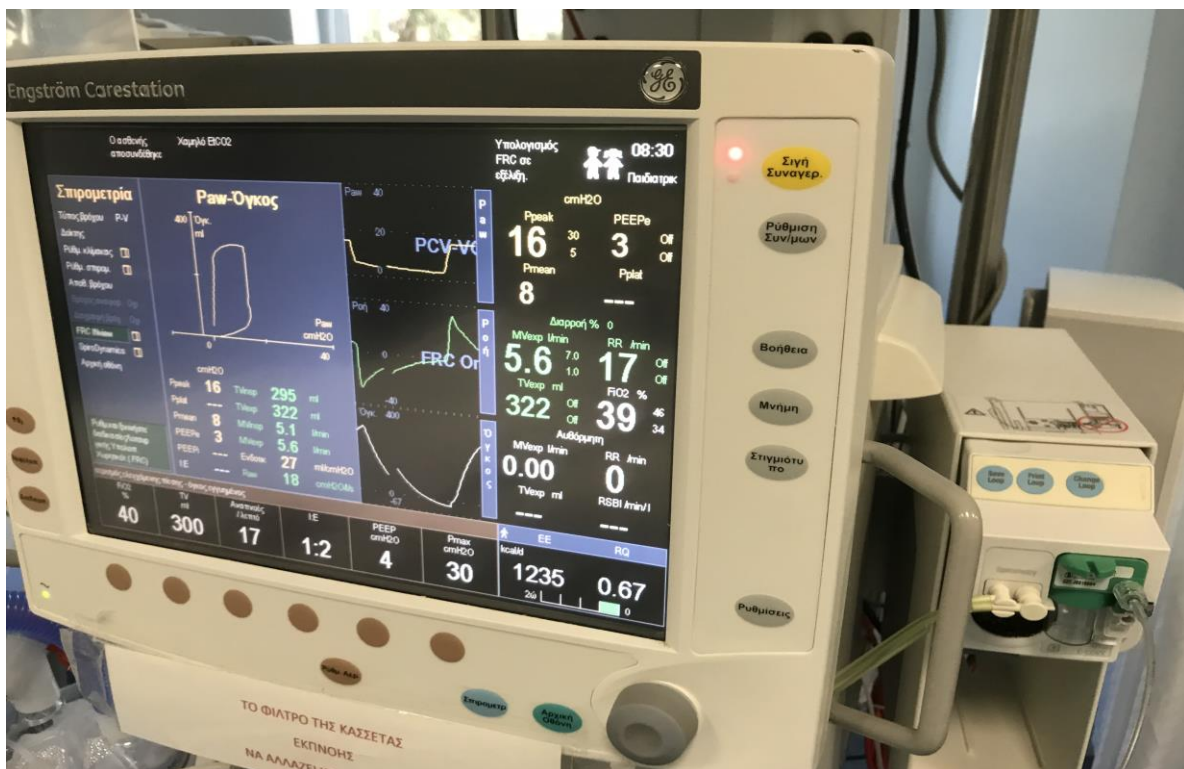
Σχήμα 1. Το μεταβολικό μόνιτορ E-COVX στη θέση ενός module στον αναπνευστήρα
