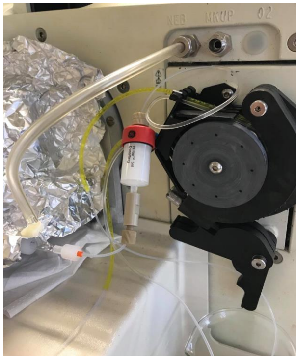
Εικόνα 13. Απεικόνιση της πειραματικής διάταξης της μεθόδου SEC-ICP-MS.
