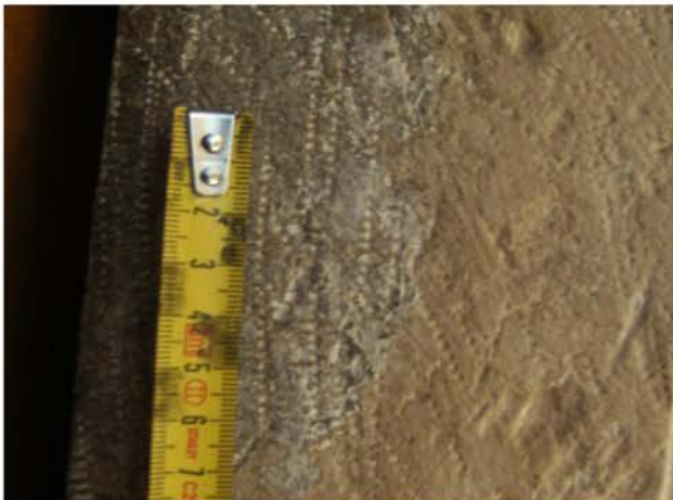
Εικ. 52 γ'. Ίχνη εργαλείου με οδοντωτή λεπίδα.
