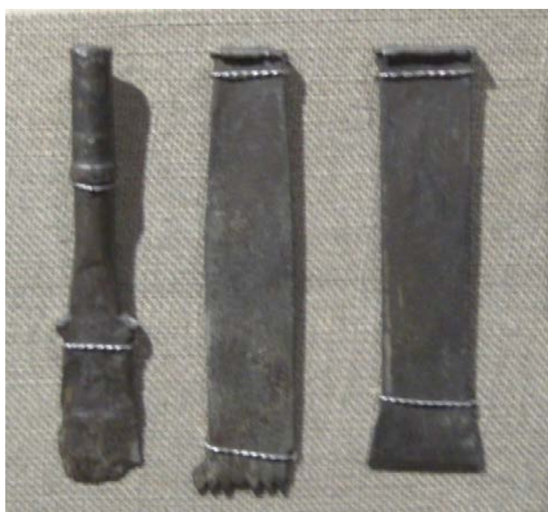
Εικ. 51. κρουόμενα εργαλεία έμμεσης κρούσης (σμίλες, σκαρπέλα). Λαογραφικό Μουσείο Γαβαλοχωρίου.
