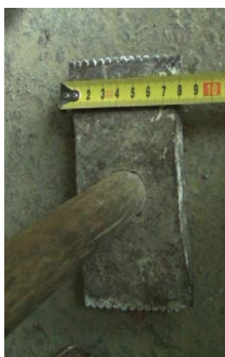
Εικ. 50. Σφυρί του πελεκιού /θραπίνα: α'. Λαογραφικό Μουσείο Γαβαλοχωρίου, β'-γ'. εργαλεία του τεχνίτη Μανόλη Πιτσουλάκη.
