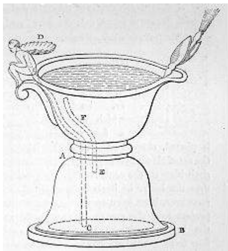
Εικόνα 49. Απλούστερο σύστημα του Ήρωνα για τη συνεχή τροφοδότηση του λύχνου με καύσιμο υλικό (σχεδιαστική αποκατάσταση). www.history.rochester.edu
