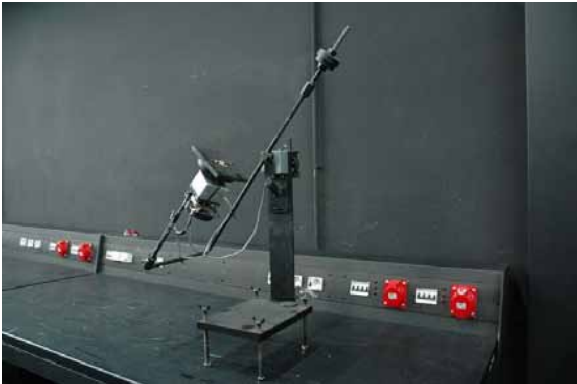
Το γωνιοφωτόμετρο για τη χάραξη διαγραμμάτων πολικής κατανομής φωτεινής έντασης.
