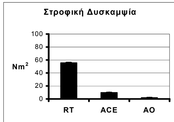
Γράφημα 9(B.2.1-9) και 10(B.2.1-10). Αξονική και Στροφική δυσκαμψία ολοκλήρου του ήλου των μελετηθέντων ήλων τριών διαφορετικών συστημάτων.
