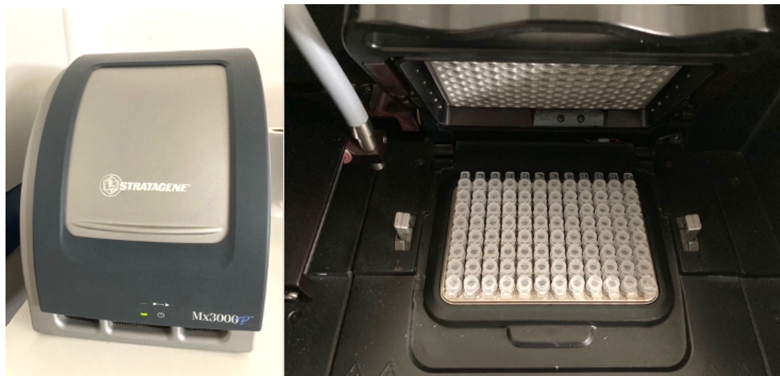
Εικόνα 13: Συσκευή Mx3000P real-time PCR thermal cycler με χρήση software version 4.1 (Stratagene, La Jolla, CA) του εργαστηρίου Ιολογίας της Ιατρικής Σχολής του Πανεπιστημίου Κρήτης και τοποθέτηση των δειγμάτων.
