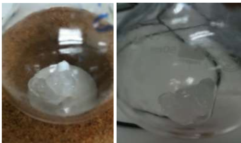
Σχήμα 54: Εικόνες από το ίζημα που δημιουργήθηκε σε φιάλη της αντίδρασης μετά το τέλος των πολυμερισμών C, C 1 και C 2 .
