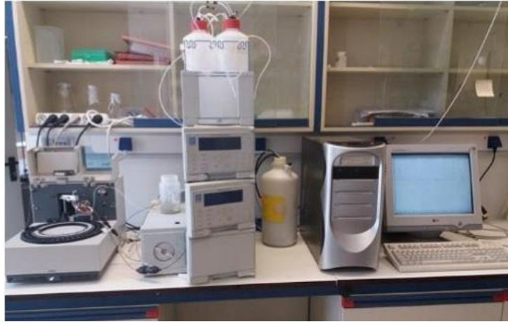
Εικόνα 6. Πειραματική διάταξη ανιοντικής Χρωματογραφίας
