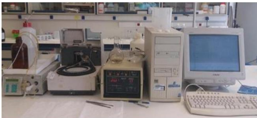
Εικόνα 5. Πειραματική διάταξη κατιοντικής Χρωματογραφίας
