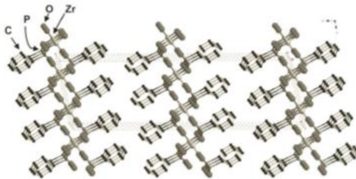
Εικόνα 3: Φυλλόμορφη δομή ένωσης \text{Zr}(\text{O}_3\text{PR})_2 9
