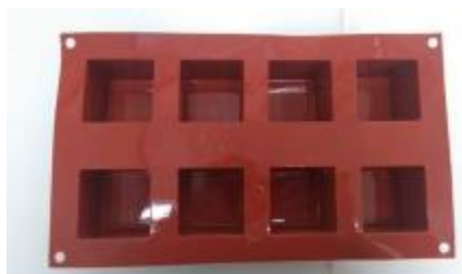
Εικόνα 15: Καλούπι σιλικόνης στο οποίο παρασκευάζονται τα τεχνητά δοκίμια γύψου
