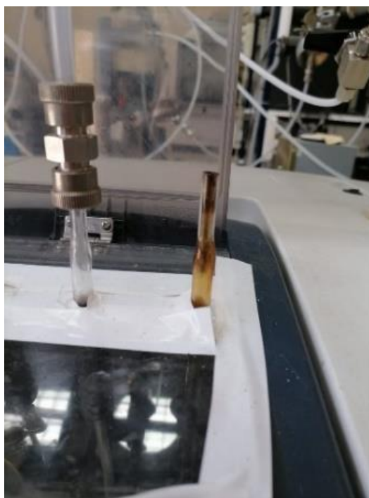
E – 4.5.1.1: Είσοδος οπτικού κελιού ανίχνευσης της διάταξης TPCR. Το μαύρο ίζημα που έχει σχηματιστεί οφείλεται στην ετερογενή κατανάλωση του 2-μεθυλ-φουρανίου παρουσία Cl_2 .
