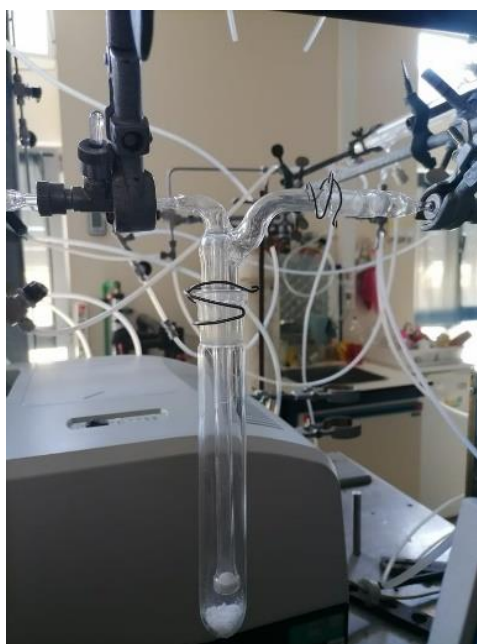
E – 4.5.1.2: Γυάλινο bubbler που χρησιμοποιήθηκε για τη μεταφορά της τάσης ατμών του μαλεϊκού ανυδρίτη (λευκό στερεό) εντός του αντιδραστήρα της διάταξης TPCR.
