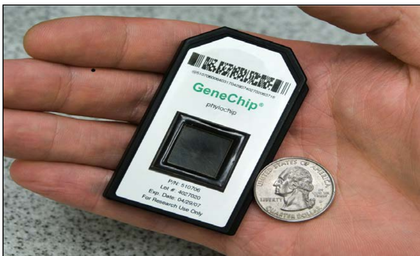
Σχήμα 7. Φωτογραφία πλακιδίου μικροσυστοιχίας PhyloChip (G3), όπως από αυτά που χρησιμοποιήθηκαν στην παρούσα πειραματική διαδικασία. Το μαύρο τετράγωνο στο κέντρο του PhyloChip είναι και η περιοχή των μονιμοποιημένων ιχνηθετών (probes)
