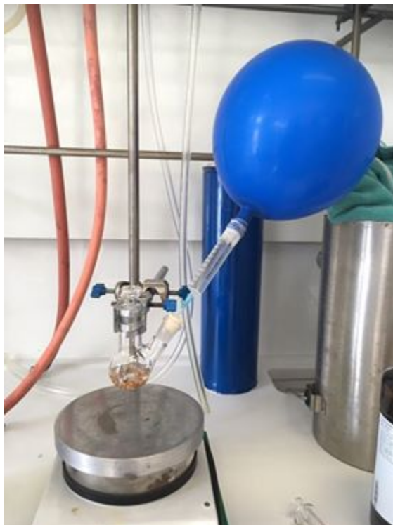
Εικόνα 21: Στοκ διάλυμα υπό τη παρουσία αζώτου.
