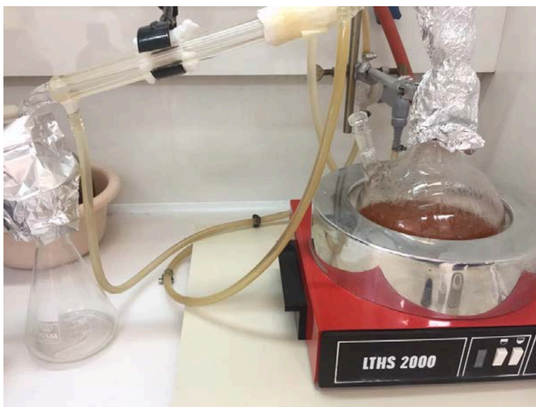
Εικόνα 10: Διαδικασία απόσταξης με σκοπό την απομάκρυνση της υγρασίας.
