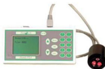
Εικόνα 13. Συσκευή Handy PEA για τις μετρήσεις του επαγωγικού φθορισμού
