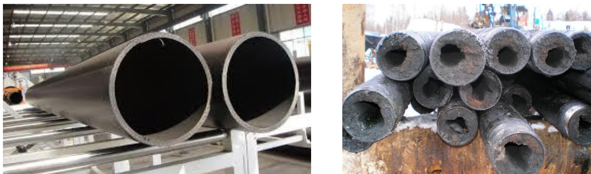
Εικόνα 3 Αριστερά αγωγοί μεταφοράς υδροθείου. Δεξιά διαβρωμένοι αγωγοί μεταφοράς λόγω του υδροθείου.
