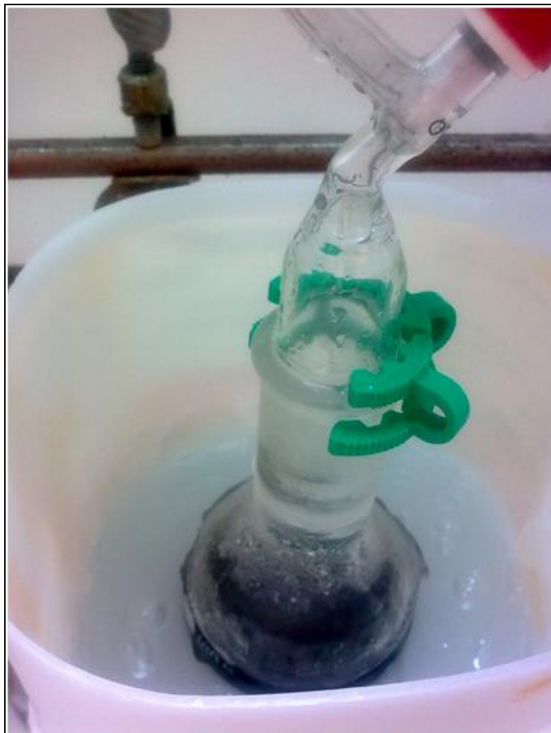
Σχήμα 2-2: Φωτογραφία της σφαιρικής φιάλης βυθισμένης σε λουτρό ακετόνης και ξηρού πάγου κατά τη διάρκεια της σύνθεσης.
