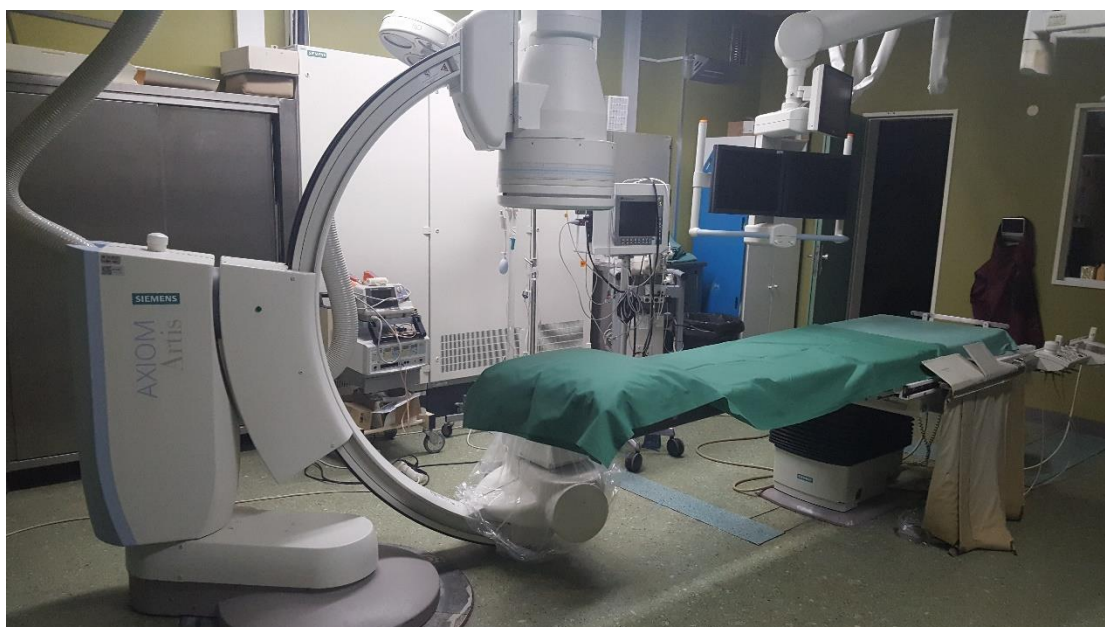
Εικόνα 5.11. Μονάδα περιφερικής αγγειογραφίας του τμήματος επεμβατικής ακτινολογίας στο ΠΑΓΝΗ. Το συγκεκριμένο σύστημα αποτελείται από ενισχυτή εικόνας με διάμετρο 40 cm.
