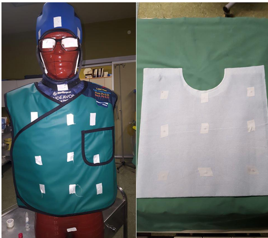
Εικόνα 6.4. Τα δοσίμετρα θερμοφωταύγειας τοποθετημένα πάνω στο ανθρωπόμορφο ομοίωμα καθώς επίσης και στο σεντόνι ακτινοπροστασίας. Πηγή [17]
