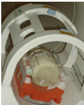
Εικόνα 8.3: Ανάγνωση ακτινοβολημένων δοσιμέτρων γέλης VIPAR N2V .
