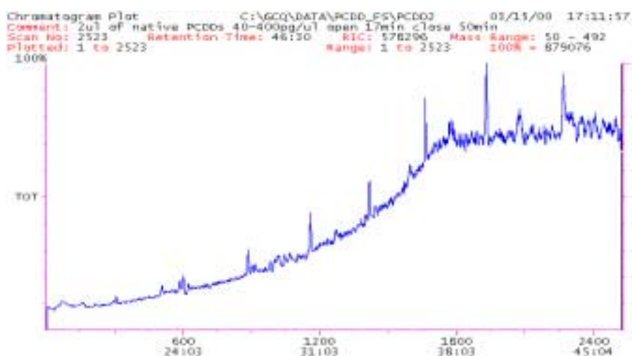
Σχ-16 Χρωματογράφημα που προέκυψε από ένεση πρότυπου διαλύματος με PCDD/Fs, φυσικής προέλευσης, στο σύστημα GCQ, το οποίο ήταν εφοδιασμένο με στήλη HP ® -5MS, κατά την εφαρμογή της μεθόδου Full Scan MS
