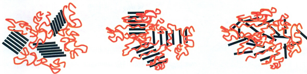
Σχήμα 1.5: Αναπαράσταση των τριών διαφορετικών δομών που εμφανίζουν τα νανοσύνθετα υλικά πολυμερών/πολυστρωματικών πυριτιούχων πηλών: (α) φασικά διαχωρισμένη, (β) δομή παρεμβολής και (γ) διεσπαρμένη δομή.
