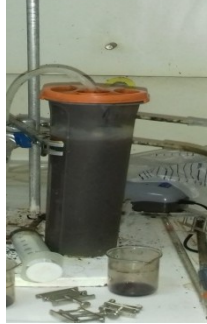
Εικόνα 9: Αντιδραστήρας SBR περιοδικής λειτουργίας αερόβιας επεξεργασίας.
