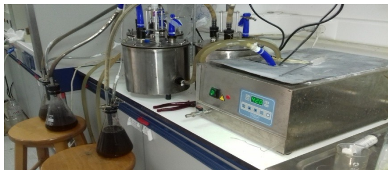
Εικόνα 8: Αντιδραστήρας αναερόβιας χώνευσης.
