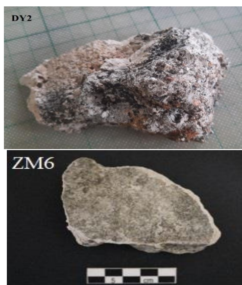
Σχήμα 16 Δείγματα κονιάματος (DY2 και ZM6)
