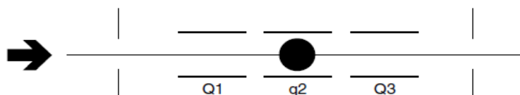
Εικόνα 11. Σχηματική διάταξη συζευγμένης φασματομετρίας μάζας τριπλού τετραπόλου (Mass spectrometry: Principles and Applications, Third Edition, Edmond de Hoffmann and Vincent Stroobant)
