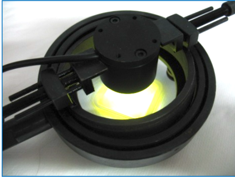
Εικόνα 19: Στην εικόνα φαίνεται η πειραματική διάταξη που χρησιμοποιήθηκε για την ακτινοβόληση των κερατοειδών με υπεριώδη ακτινοβολία.
