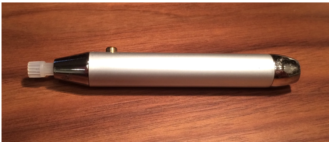
Εικόνα 18: Η βούρτσα απόξεσης αποτελείται από την ειδική άκρη η οποία εφαρμόζει σε περιστρεφόμενο μοτέρ με την βοήθεια του οποίου περιστρέφεται γύρο από τον άξονα της. (αρχείο ΒΕΜΜΟ)
