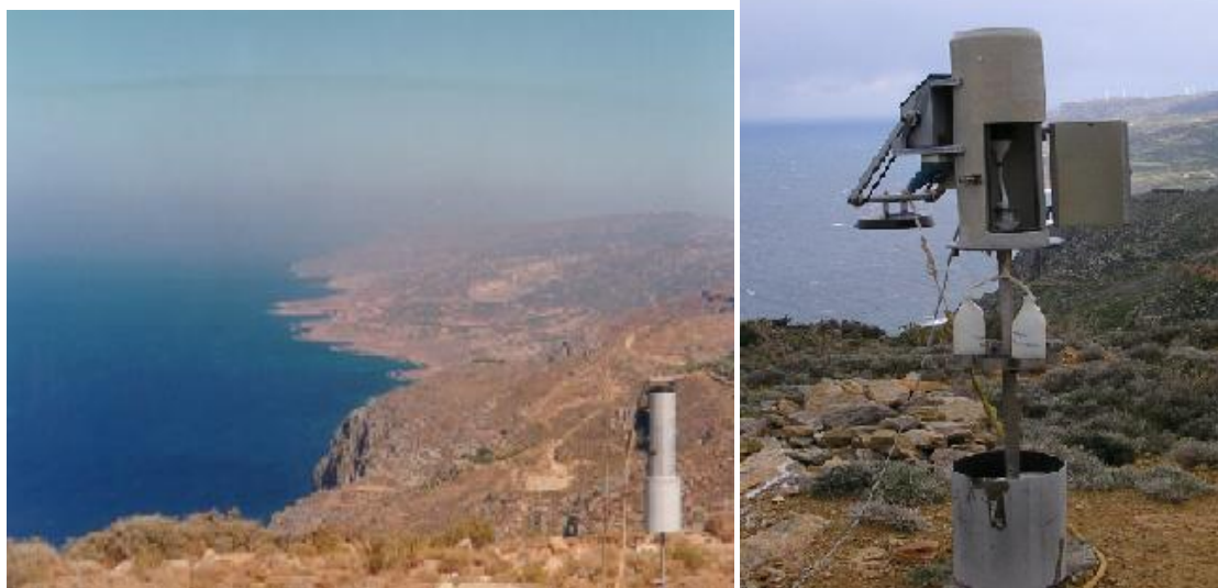
Εικόνα 2.4: Αυτόματος δειγματολήπτης στον σταθμό του Φινοκαλιά ((ECPL, (2021). Finokalia Station. Διαθέσιμο στο: https://finokalia.chemistry.uoc.gr/about/ ).
