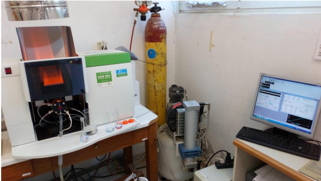
Εικόνα 2.18. Μετρήσεις μετάλλων με φασματοφωτόμετρο ατομικής απορρόφησης (Perkin Elmer 400).
