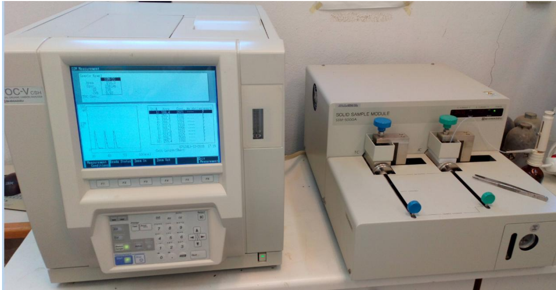
Εικόνα 2.14. Αναλυτής TOC-V της εταιρίας Shimadzu με τον οποίο πραγματοποιήθηκε η μέτρηση.
