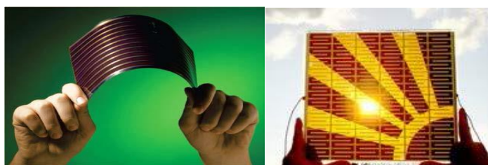
Σχήμα 1.24: Απεικόνιση των DSSC για τη διασαφήνιση της ελαστικότητας και της διαφάνειας των συγκεκριμένων ηλιακών κυψελίδων. 63
