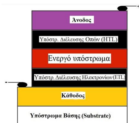
Σχήμα 3.1: Απεικόνιση της ανεστραμμένης διάταξης μίας φωτοβολταϊκής κυψελίδας.
