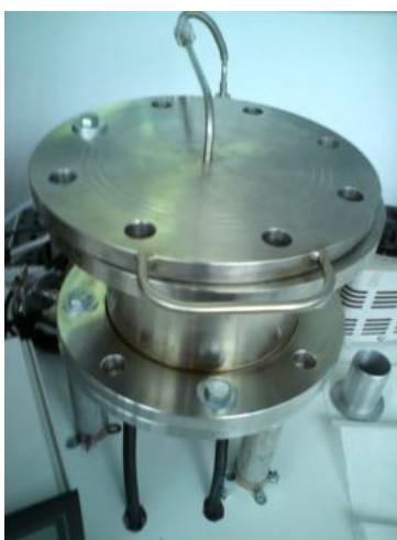
Σχήμα 3.3: Αντιδραστήρας συστήματος εναπόθεσης οξειδίου.
