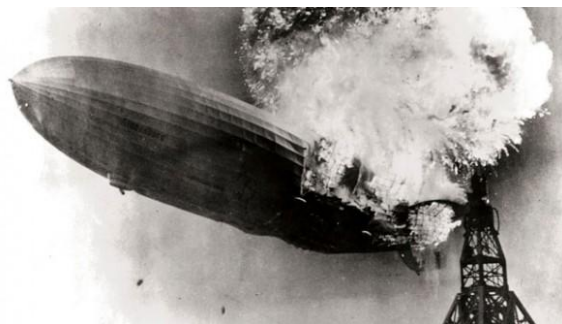
Σχήμα 1.24: Ο στατικός ηλεκτρισμός προκάλεσε πυρκαγιά στο αερόπλοιο.
