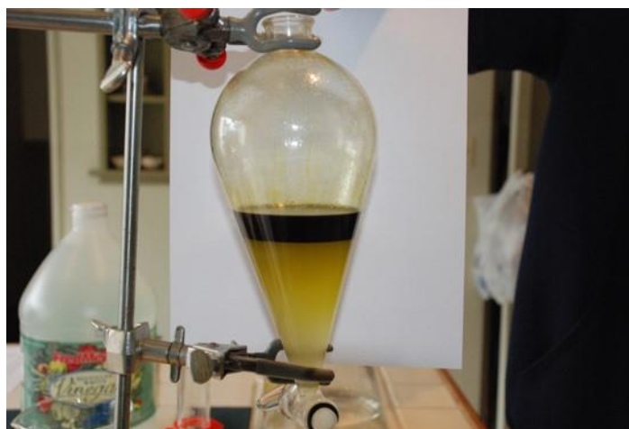
Εικόνα 3.11 Ο διαχωρισμός των δύο φάσεων επιτυγχάνεται με τη βοήθεια διαχωριστικής χοάνης. Η οργανική (πάνω) φάση περιέχει το επιθυμητό σύμπλοκο σιδήρου - ελαϊκών
