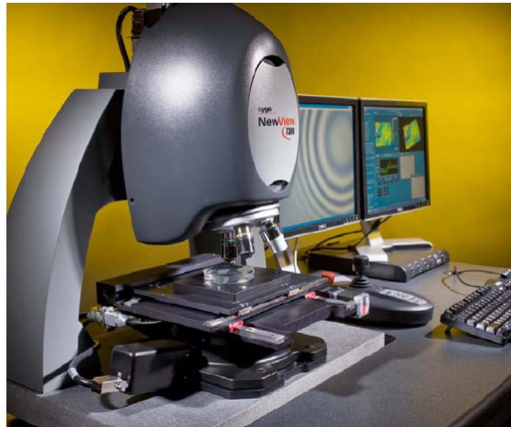
Εικόνα 1. Προφιλόμετρο NewView™ 7300 της εταιρείας Zygo.
