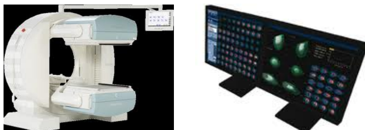
Εικόνα 45. Γ- κάμερα διπλής κεφαλής με το υπολογιστικό σύστημα στο οποίο μεταφέρονται οι πληροφορίες.
