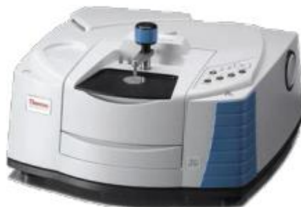
Εικόνα 1.15: Φασματόμετρο Υπέρυθρου Μετασχηματισμού Fourier (FTIR) Nicolet 6700 Thermoscientific, με Αποσβένουσα Ολική Ανάκλαση (ATR)
