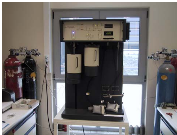
Σχήμα 4. Εμπορικό ογκομετρικό σύστημα ρόφησης αερίων που χρησιμοποιήθηκε για την προσρόφηση N_2 στους 77K (Autosorb-1MP, Quantachrome).
