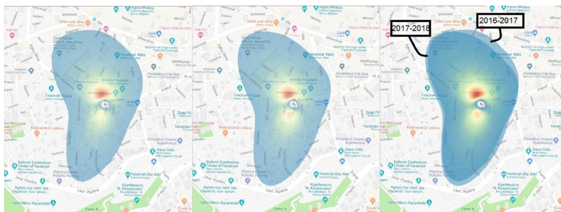
Εικόνα. 4.6 (α) Αποτύπωμα τυρβωδών ροών (αποτύπωμα περιοχής προέλευσης) για την περίοδο 01/11/16-31/10/17 (β) Αποτύπωμα τυρβωδών ροών (αποτύπωμα περιοχής προέλευσης) για την περίοδο 01/11/17-31/10/18 (γ) Σύγκριση των δύο αποτυπωμάτων.
