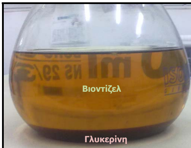
Εικόνα 6.11: Δοκιμή «Πιλότος» δείγματος HWastOil-1 (διαύγεια βιοντίζελ μετά από 2 μέρες).
