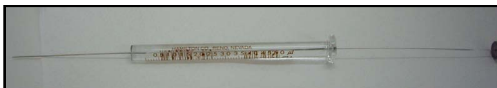
Εικόνα 7.23: Μικροσύριγγα για εισαγωγή δείγματος στον χρωματογράφο.
