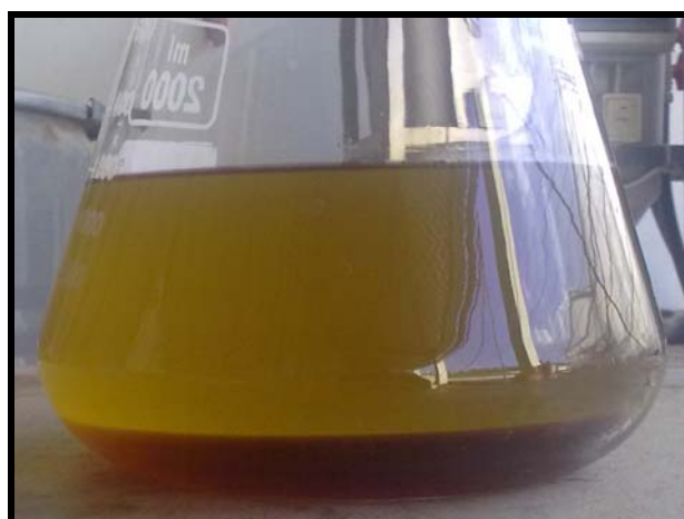
Εικόνα 6.31: Δοκιμή «Πιλότος» δείγματος EWastOil-2 (διαχωρισμός βιοντίζελ – γλυκερίνης 1 ώρα).
