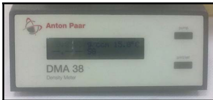
Εικόνα 7.7: Ρύθμιση - Μέτρηση Πικνότητας στους 15°C.
