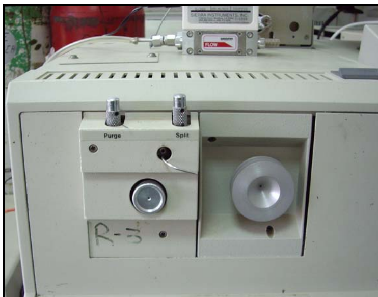
Εικόνα 7.24: Σύστημα Εισαγωγής Χρωματογράφου.
