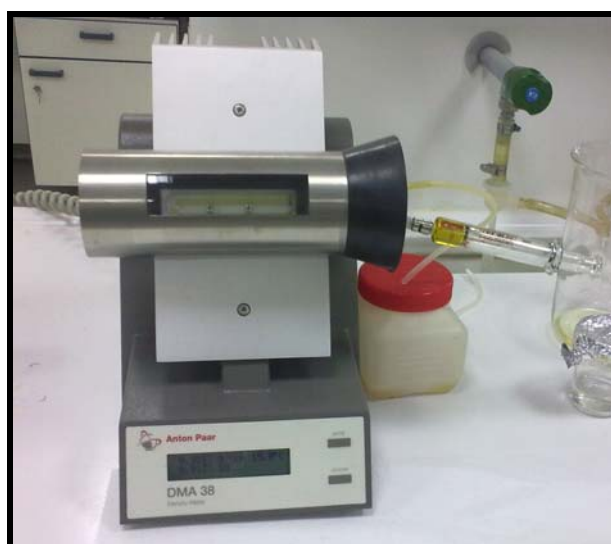
Εικόνα 7.10: Μέτρηση Πικνότητας – Σταθεροποίηση Ένδειξης.
