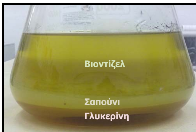
Εικόνα 6.32: Δοκιμή «Πιλότος» δείγματος EWastOil-2 (μετά από 2 μέρες).
