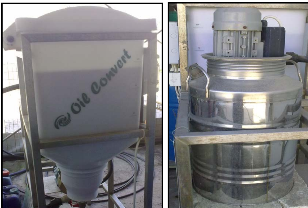
Εικόνα 6.2: Δοχείο Αποθήκευσης Ελαίου και Ανάμιξης μεθανόλης με καταλύτη.
