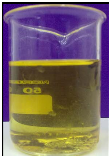
Εικόνα 6.28: Τελικό προϊόν HBio-1 μετά την Υγρή Πλύση.
