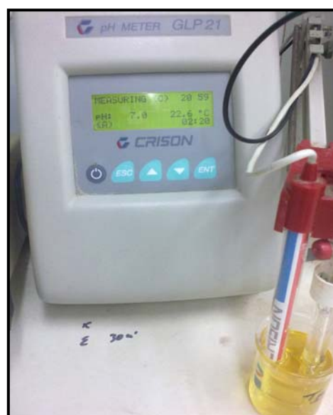
Εικόνα 7.26: Μέτρηση pH μετά την έκλυση.
