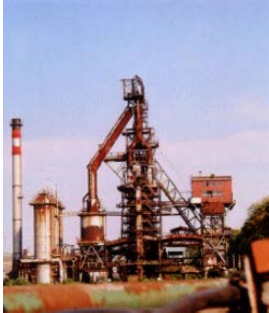
Εικόνα 2 : Παραγωγή μεταλλικού σιδήρου από αιματίτη σε ειδικό φούρνο (Blast furnace) στο Σεστάο της Ισπανίας. Ο πραγματικός φούρνος βρίσκεται εσωτερικά αυτής της κατασκευής.
