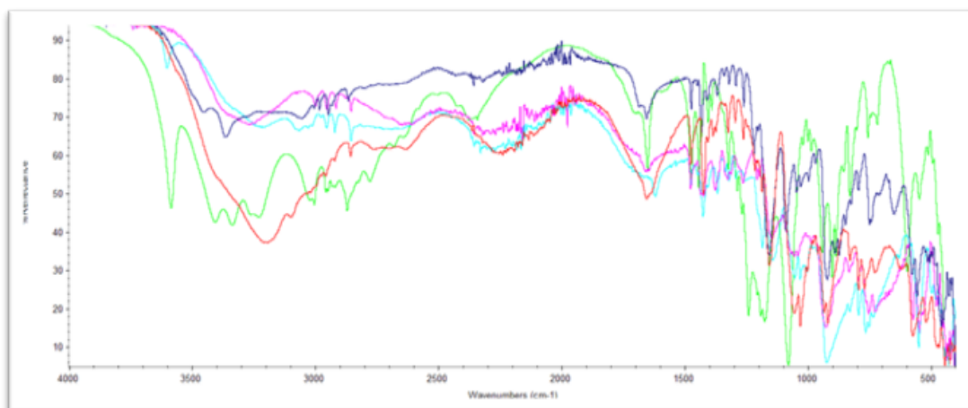
Εικόνα 2.1 Φάσματα FT-IR των υλικών Li(HDTMP) (ανοιχτό πράσινο), Na(HDTMP) (κόκκινο), K(HDTMP) (μπλέ), Rb(HDTMP) (γαλάζιο), και Cs(HDTMP) (μώβ).
