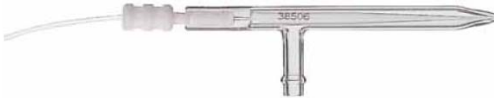
Σχήμα 1.10 Σχηματική αναπαράσταση ενός πνευματικού ομόκεντρου εκνεφωτή ( http://perso.wanadoo.fr/courtage.analyses.services/icp/productsge/nebs/Slurries/ar301fs6.html ).
