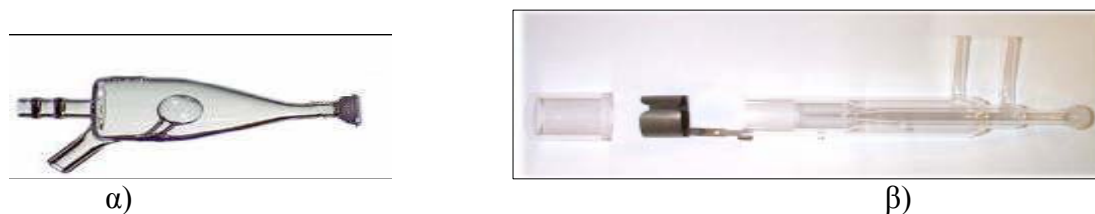
Σχήμα 2.1 α) Θάλαμος εκνέφωσης από γυαλί και β) Πυρσός πλάσματος από χαλαζία θάλαμος εκνέφωσης από γυαλί.
