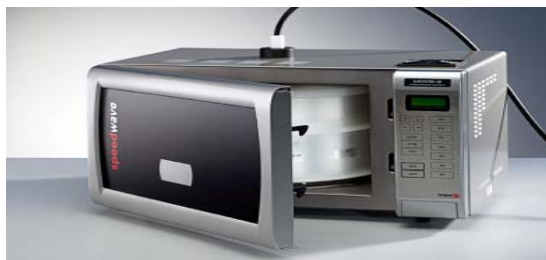
Σχήμα 2.2 Συσκευή Όξινης Χώνευσης με τη χρήση ακτινοβολίας μικροκυμάτων
