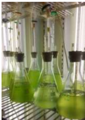
Εικόνα 2.1: Κωνικές φιάλες ανάπτυξης των κυανοβακτηρίων με τους δυο σωλήνες υποδοχής φιλτραρισμένου αέρα και εκτόνωσης αντίστοιχα σε ειδικά διαμορφωμένο θάλαμο.
