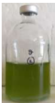
Εικόνα 2.2: Βιοαντιδραστήρας δύο φάσεων (υγρή/αέρια) χωρητικότητας 100 mL, με ύψος 9,5 cm και διάμετρο 5 cm.
