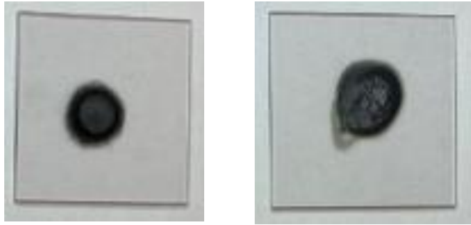
Εικόνα 38: Γυαλί τύπου fused silica με επίστρωση θερμοχρωμικού υλικού με Drop casting.
