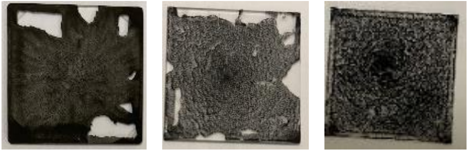
Εικόνα 42: Γυαλί τύπου fused silica με επίστρωση θερμοχρωμικού υλικού με Spin coating (α) Glycolic (b) L-Ascorbic (c) Tartaric acid.
