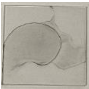
Εικόνα 40: Γυαλί τύπου fused silica με επίστρωση θερμοχρωμικού υλικού με Spin coating
