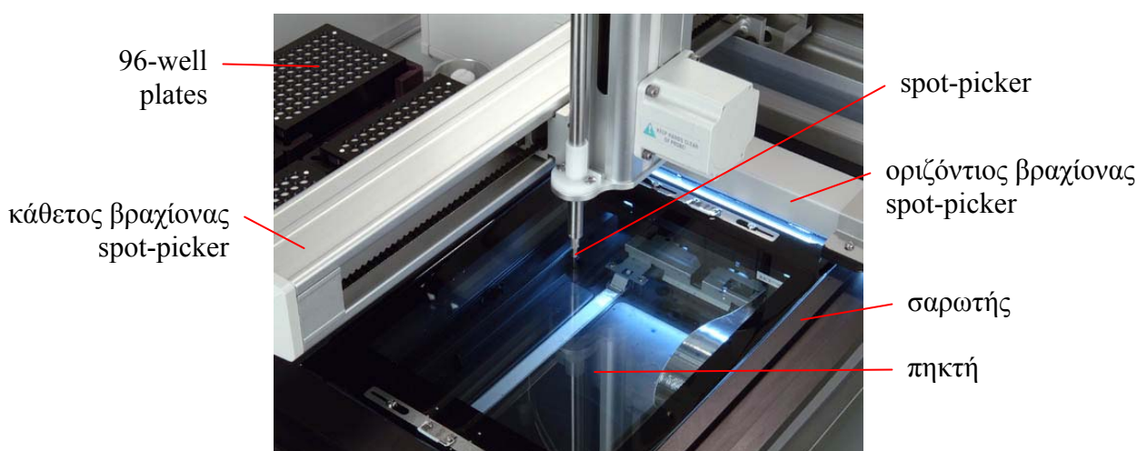
Εικόνα 2.9 Το σύστημα Bruker Spot Picker system, για την αυτόματη συλλογή πρωτεϊνικών κηλίδων (spots) από πηκτές δισδιάστατης ηλεκτροφόρησης. Η πηκτή σαρώνεται, η εικόνα καταλήγει σε υπολογιστή όπου καθορίζεται η θέση του κάθε spot, και στη συνέχεια δίνεται η εντολή για την συλλογή του.
