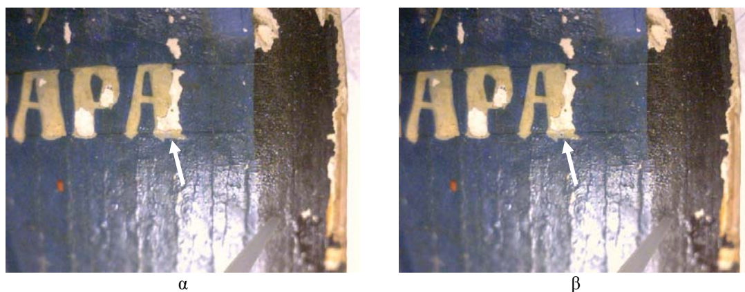
Εικόνα 5.12: Φωτογραφίες από την κάμερα του συστήματος, α) πριν την ανάλυση με LIBS και β) μετά την ανάλυση. Στην μύτη του λευκού βέλους φαίνεται ακριβώς το σημείο που αναλύθηκε
