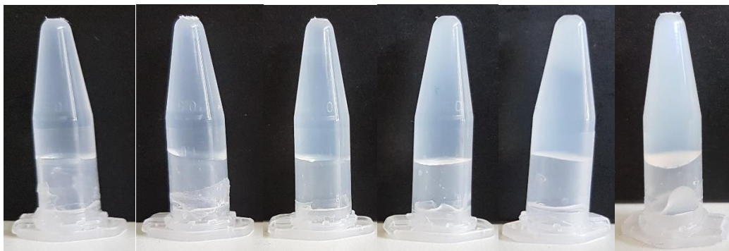
Εικόνα 3.18. Αποφυλλοποιημένο LDH σε γλυκερίνη σε συγκεντρώσεις 1, 2, 5, 10, 20 και 40 g/L, μετά το πέρασμα 12 μηνών.
