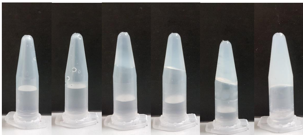
Εικόνα 3.16. Αποφυλλοποιημένο LDH σε φορμαμίδιο σε συγκεντρώσεις 1, 2, 5, 10, 20 και 40 g/L, μετά το πέρασμα 12 μηνών.
