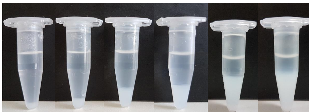
Εικόνα 3.17. Αποφυλλοποιημένο LDH σε προπυλενογλυκόλη σε συγκεντρώσεις 1, 2, 5, 10, 20 και 40 g/L, μετά το πέρασμα 12 μηνών.
