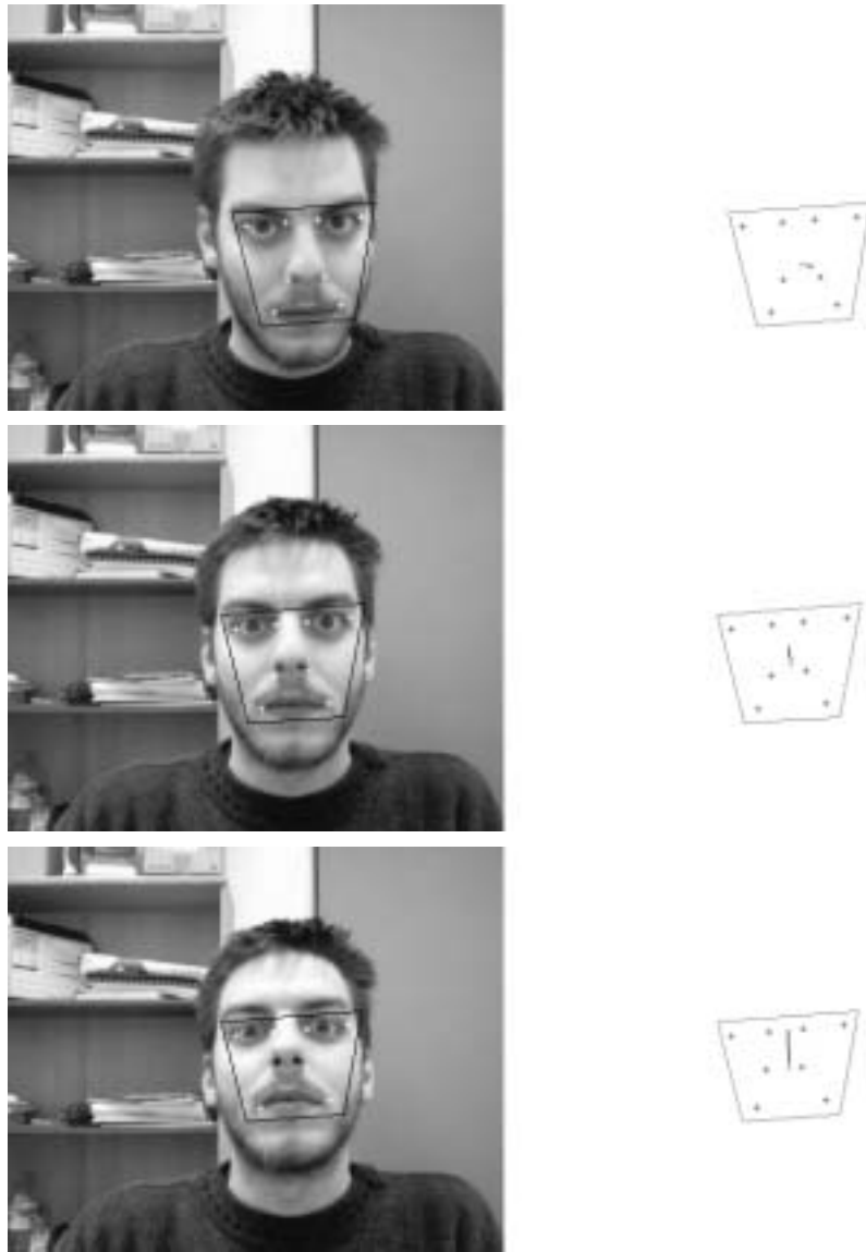
Σχήμα 6.6: Στις παραπάνω εικόνες βλέπουμε τα αποτελέσματα της ολοκληρωμένης μεθόδου, παρακολούθηση σημείων και εκτίμηση πόζας, για αποσπάσματα από την ακολουθία ‘kutsurak’. Από πάνω προς τα κάτω τα αποτελέσματα αντιστοιχούν στις εικόνες 1, 15, 25, 35, 50, 70, 85, 100, 115, 135, 155.
