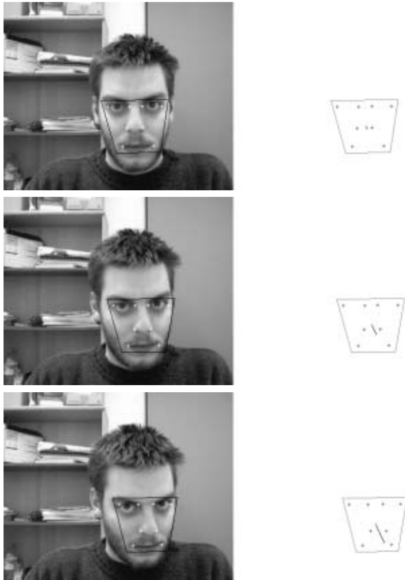
Σχήμα 6.7: Στις παραπάνω εικόνες βλέπουμε τα αποτελέσματα της ολοκληρωμένης μεθόδου, παρακολούθηση σημείων και εκτίμηση πόζας, για αποσπάσματα από την ακολουθία ‘kutsurak’. Από πάνω προς τα κάτω τα αποτελέσματα αντιστοιχούν στις εικόνες 220, 230, 240, 255, 270, 280, 295.
