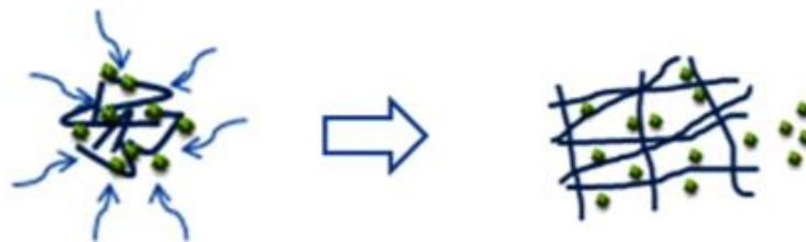
Εικόνα 21. Μηχανισμός αποδέσμευσης μέσω διόγκωσης του δικτύου της υδρογέλης. Η εικόνα λήφθηκε από την παραπομπή [40].
