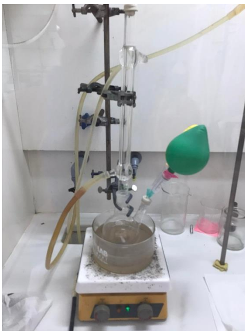
Εικόνα 31. Πειραματική διάταξη οργανικής τροποποίησης του αργίλου Laponite ® μέσω one-pot αντίδρασης με τα οργανοσιλάνια APTES και TESPSA. Τα βασικά μέρη ήταν: θερμαντική, λουτρό σιλικονέλαιου, δίλιμη σφαιρική, επίθεμα septum, μπαλόني αέριου N 2 , και κάθετος ψυκτήρας.
