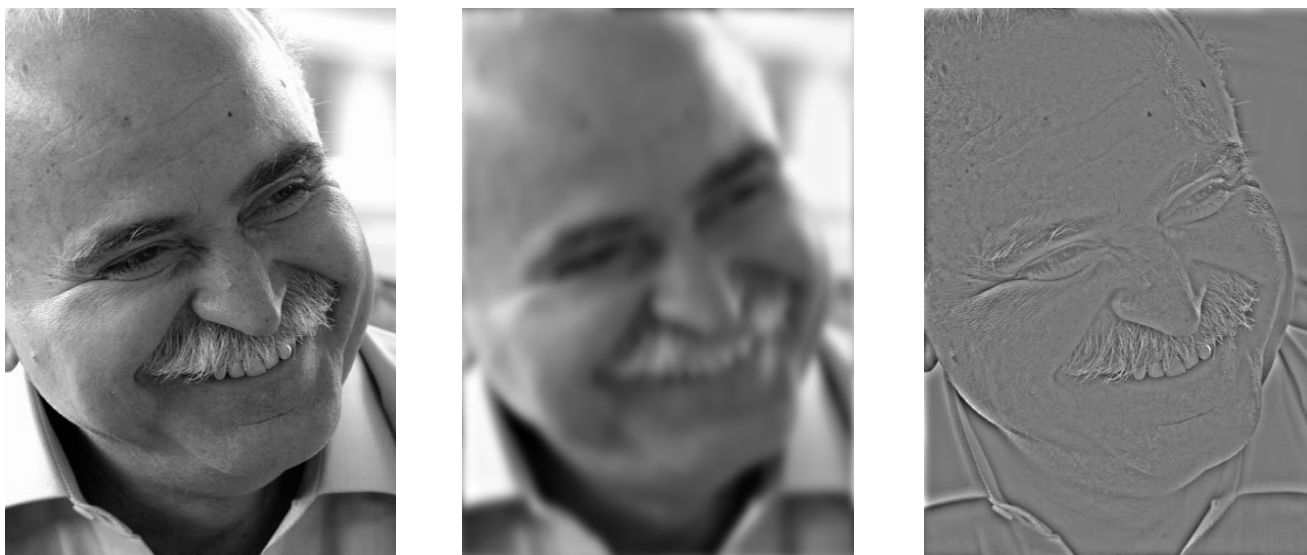
Σχήμα 2.15: Αρχική εικόνα (αριστερά), χαμηλές και μεσαίες χωρικές συχνότητες (κέντρο), μεσαίες και υψηλές χωρικές συχνότητες (δεξιά).
