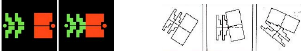
Εικόνα 5: Ομαλά-ευθυγραμμισμένα είδωλα στο κερατόμετρο Javal (αριστερά), Γωνία Amsler (δεξιά)
