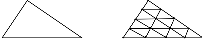
Σχήμα 4.7: Αριστερά το αρχικό τρίγωνο και δεξιά η δυο φορές ομοιόμορφη εκλέπτυνση του.
