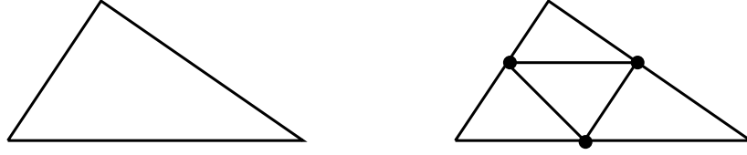
Σχήμα 4.5: Αριστερά το αρχικό τρίγωνο και δεξιά η διάσπαση του σε τέσσερα μικρότερα τρίγωνα.
